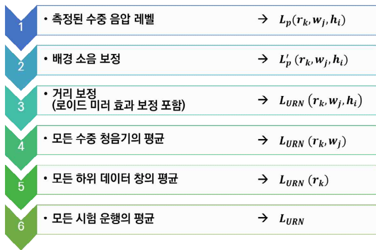
그림 3.3 수중 청음기, 데이터 창, 시험 운행에 대한 데이터 후처리 계획
